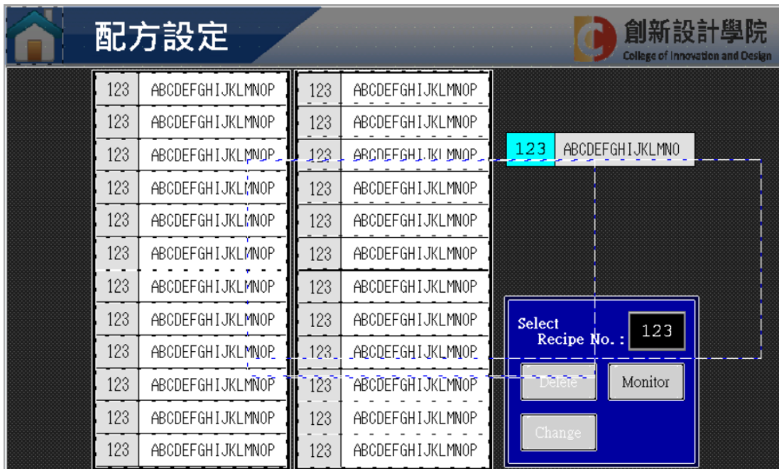
圖參-10 HMI 配方選擇畫面設計
