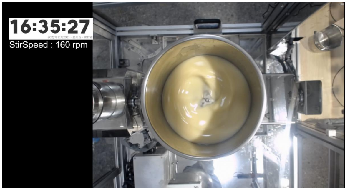
圖 肆-21 攪拌桶監控畫面（攪拌 15 分鐘）
