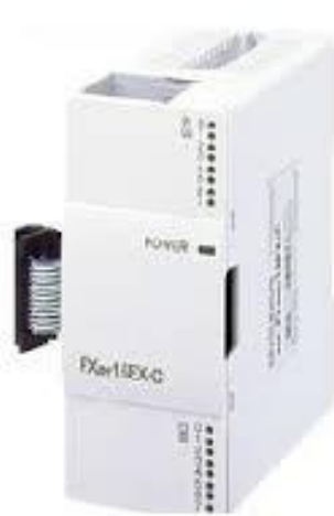
圖 貳-6 三菱 PLC FX1N/FX3G/FX3U 共用擴充 IO 模組
