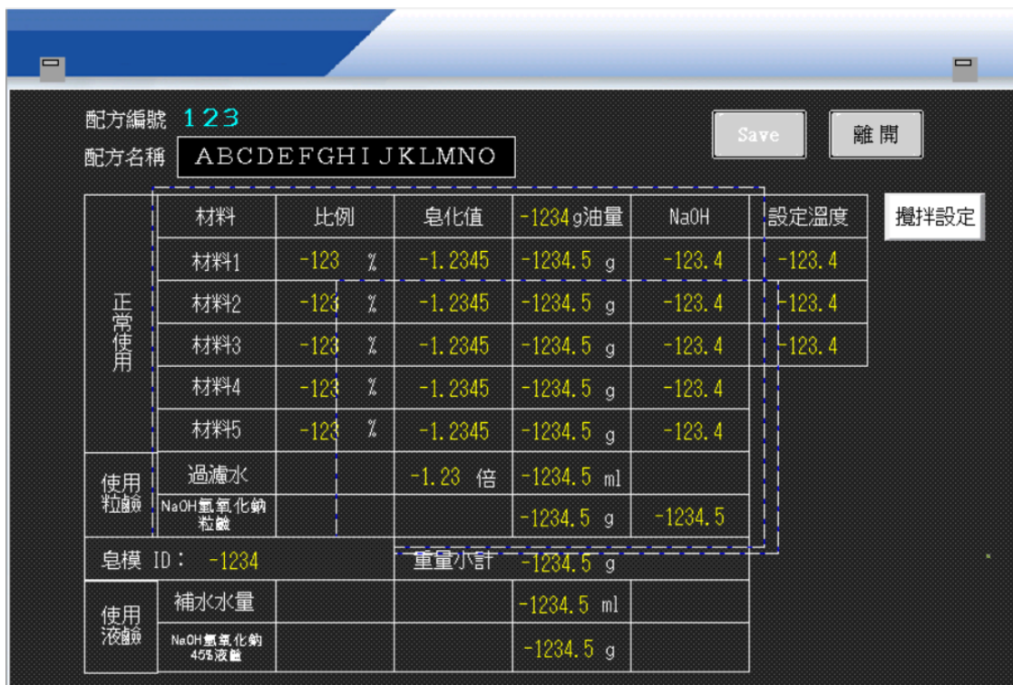
圖參-11 HMI 配方設定畫面
