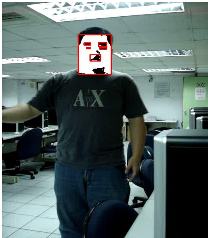
圖 66 單人候選臉 Connected-Component 後並做條件判斷。
