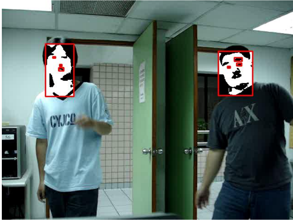
圖 67 雙人候選臉 Connected-Component 後並做條件判斷。
