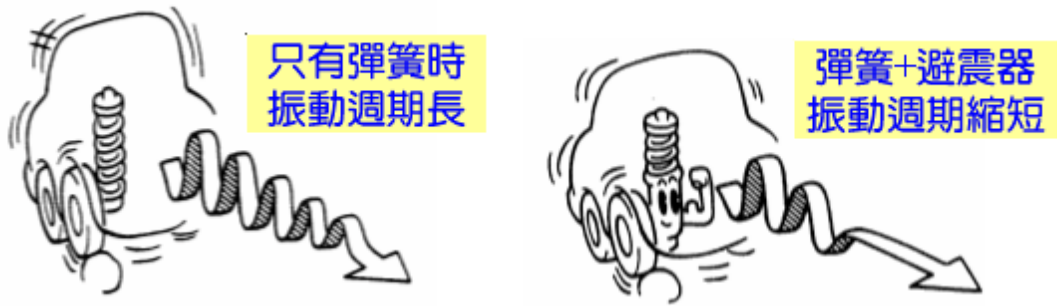
圖 1、圖 2 避震器的示意圖
