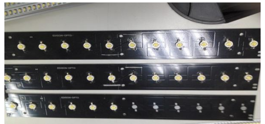
8. LED(10 瓦) PS:晶片打在鋁基板上
